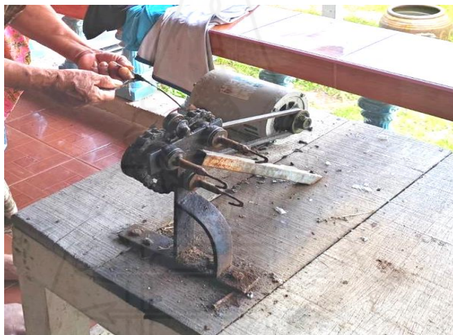
ภาพที่ 3 แสดงเครื่องพันเกลียวเชือกแบบภูมิปัญญาชาวบ้าน
